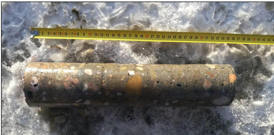
Obr. č. 1 - diagnostický návrť N1 - levé čelo NK
