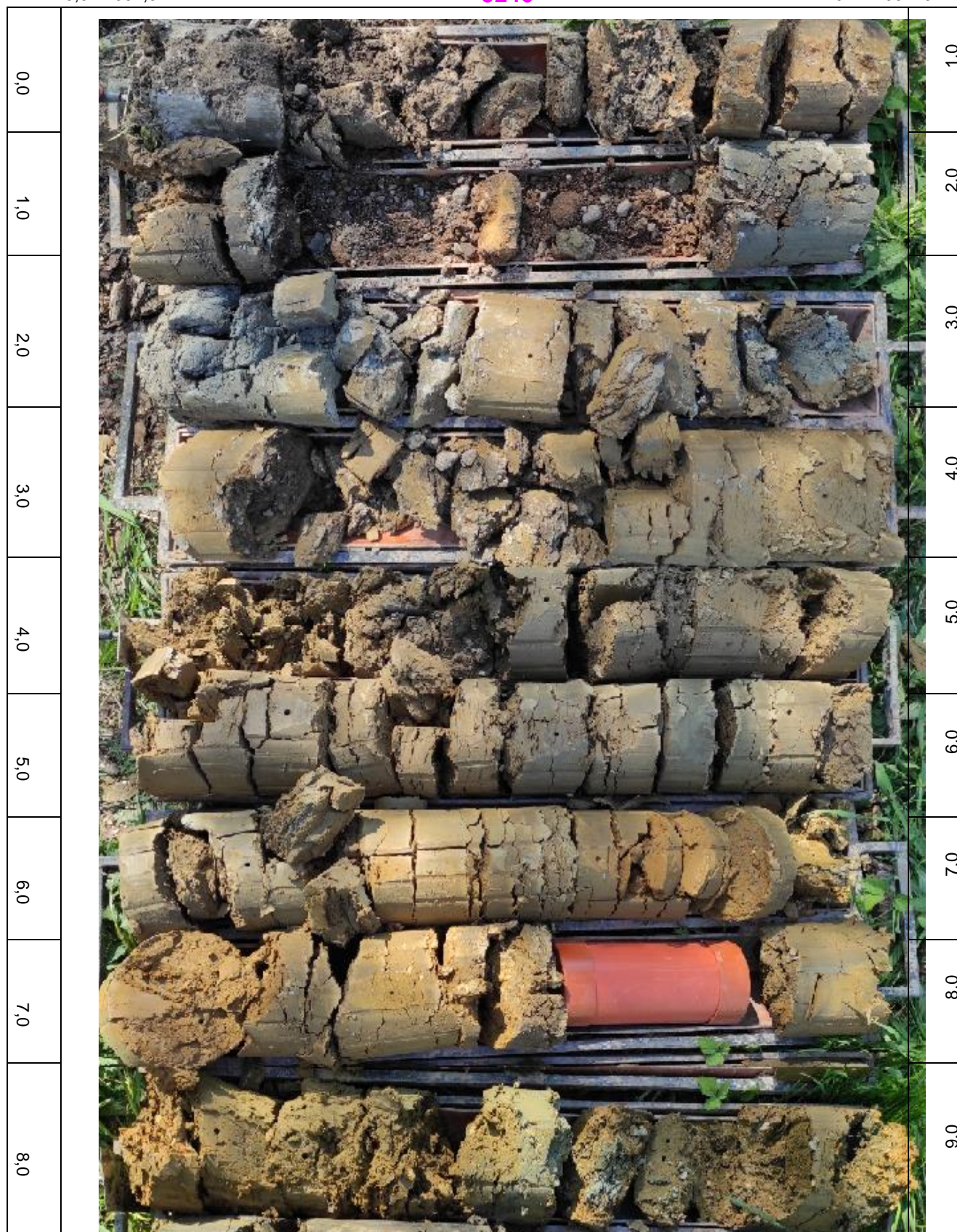
Obr. č. 21 – Fotodokumentace vrtného jádra v intervalu 0 – 9,0 m
