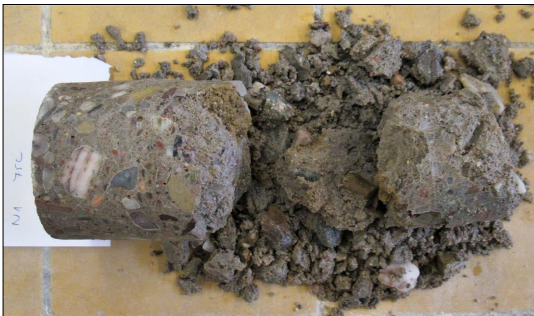
Foto 3: Vzorek N1 při zkoušce mrazuvzdornosti – 75 zatěžovacích cyklů Rozlomení vzorku a dále rozpad velké části zkušebního tělesa, zkouška byla ukončena
