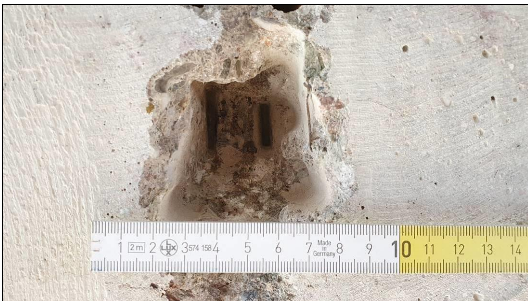
Obr. č. 19 - destruktivní bodová sonda DRN4 do NK
