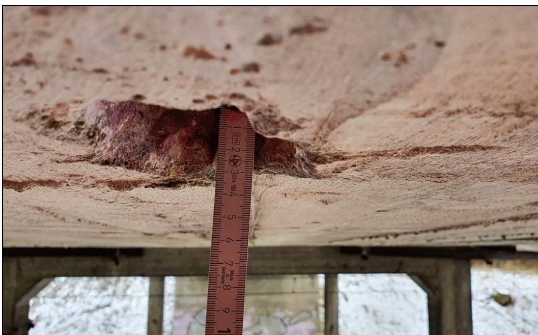
Obr. č. 20 - pohled na měření krytí výztuže v NK
