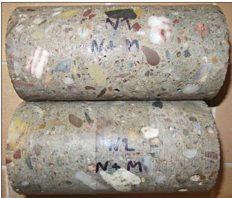
Foto 2: Pohled na vzorky N1 a N2 před zkouškou mrazuvzdornosti
