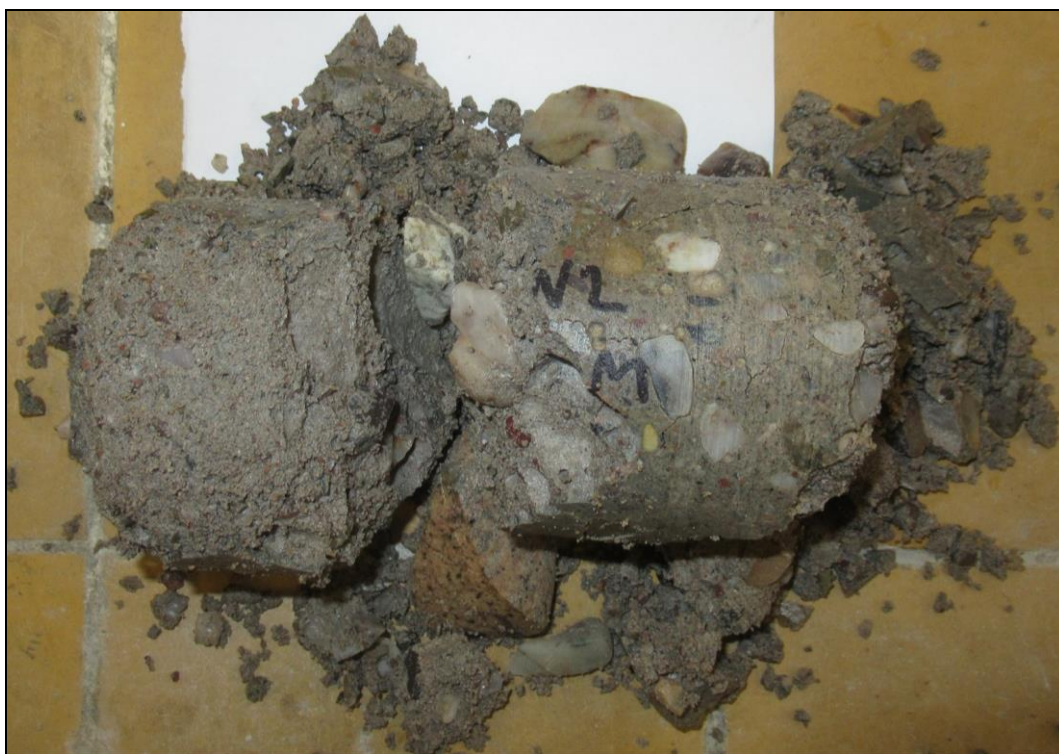
Foto 4: Vzorek N2 po zkoušce mrazuvzdornosti – 50 zatěžovacích cyklů Rozlomení vzorku a dále rozpad velké části zkušebního tělesa, zkouška byla ukončena
