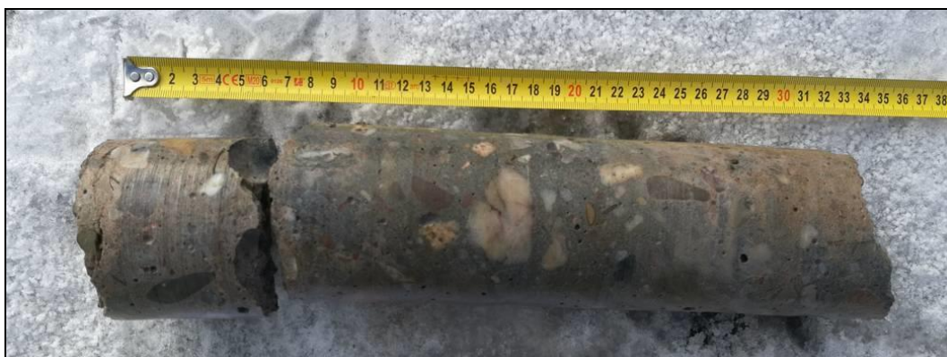
Obr. č. 2 - diagnostický návrť N2 - pravé čelo NK
